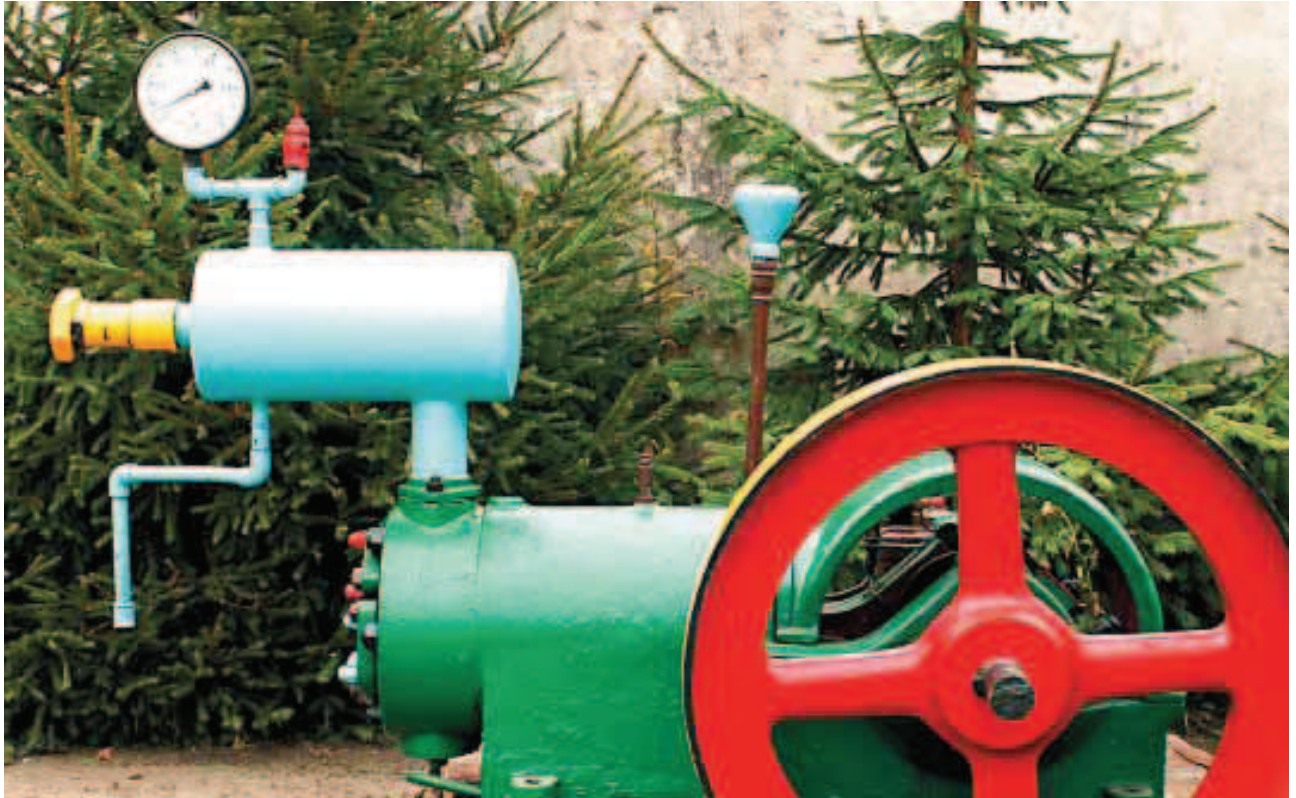
Elbląg, woj. warmińsko-mazurskie. Unikalna pompa mamutowa: sprężone powietrze dostarczane przez dmuchawę do zanurzonego w ściekach mieszacza, tworzyło z osadu emulsję, która jako lżejsza od ścieków była wypychana ku górze przewodu tłocznego (foto M.J. Kownacki, opis A. Przybylski EPWiK Elbląg)
