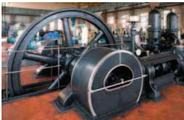
[56] Karchowice, woj. śląskie – sprężarka parowa (foto Urząd Marszałkowski w Katowicach)
