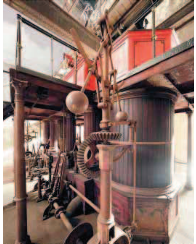
Wrocławska wieża ciśnień przy ul. Na Grobli została zaprojektowana z dbałością o detale. Na zdjęciu regulator Watta (foto M. Bury)
